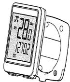
Der Tacho kann aus der Halterung genommen werden, indem dieser etwas gegen den Uhrzeigersinn gedreht wird.
