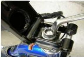
Schraube mit einem 13mm Ringschlüssel mit 12-15Nm festziehen (muss nach der ersten Fahrt nachgezogen werden)
