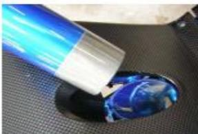
Sitzrohr in den Rahmen einführen und ausrichten.
