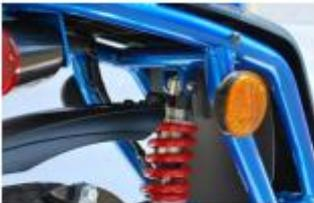
Den Spritzschutz am Federbein anbringen und die Schraube mit einem Kreuzschlitzschraubendreher handfest anziehen.
