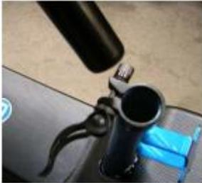
Sattelstütze in das Sitzrohr einführen und ergonomisch ausrichten.
