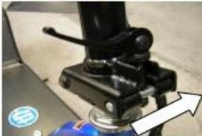
Das Faltscharnier für den Faltmechanismus muss in Fahrrichtung nach links geschoben werden um das Verschließen des Faltgelenkes zu ermöglichen.
