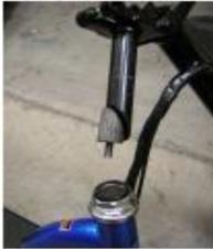
Lenkervorbau in das Steuerrohr einführen und ausrichten.
