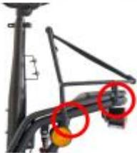
Alternativ kann statt dem Korb der mitgelieferte Gepäckträger montiert werden. Hierzu die mitgelieferten M5x15 Schrauben mit einem 5mm Inbusschlüssel auf 7-9Nm festziehen.
