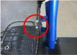
Den Korb mit den beiden M6x15 Inbusschrauben und M6 Beilagscheiben mit einem 5mm Inbusschlüssel auf 7-9Nm festziehen.
