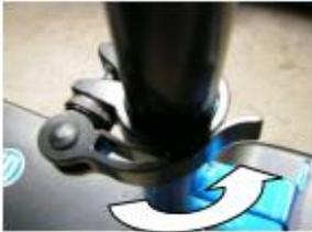
Sitzhöhe ergonomisch festlegen und Spannhebel verschließen. Durch Verstellen der Mutter am Spannhebel kann die Spannkraft reguliert werden. Der Spannhebel muss sich mit spürbarem Gegendruck schließen lassen.
