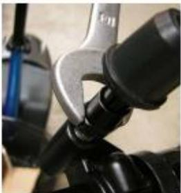
Kontermutter mit einem 15mm Maulschlüssel festziehen.
