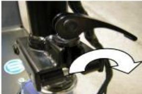
Lenkervorbau nach vorne klappen und den Spannhebel schließen. Auf festen Sitz achten!
